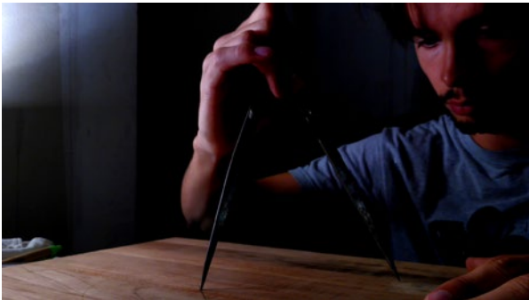
2 MARCAGE À LA POINTE DU COMPAT
