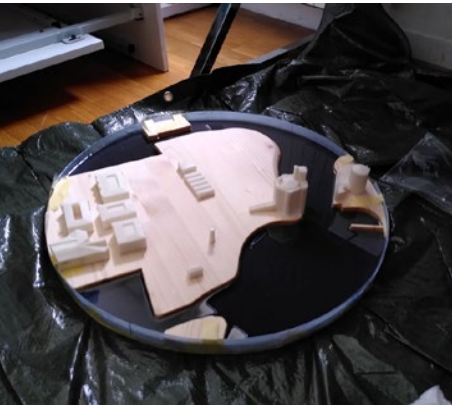
3 COFFRAGE EN PLEXYGLASSE, COULAGE ET SÉCHAGE DE LA RÉSINE EPOXY
