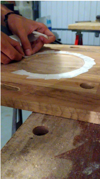
4 PRÉPARATION POUR COLLAGE DE L'ARDOISE
