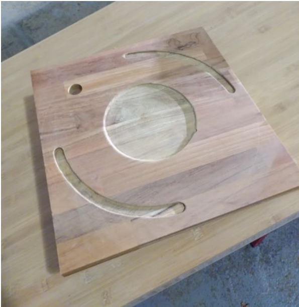
3 DEFONÇAGE DES RIGOLES ET ESCAVATION CENTRALE POUR Y INTRODUIRE L'ARDOISE
