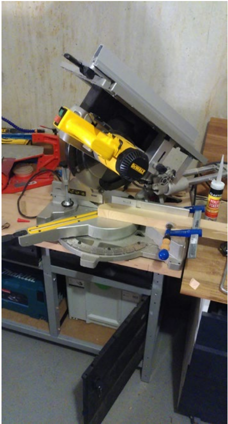
1 PRÉPARATION D'UNE POINÇON À LA SCIE À ONGLET
